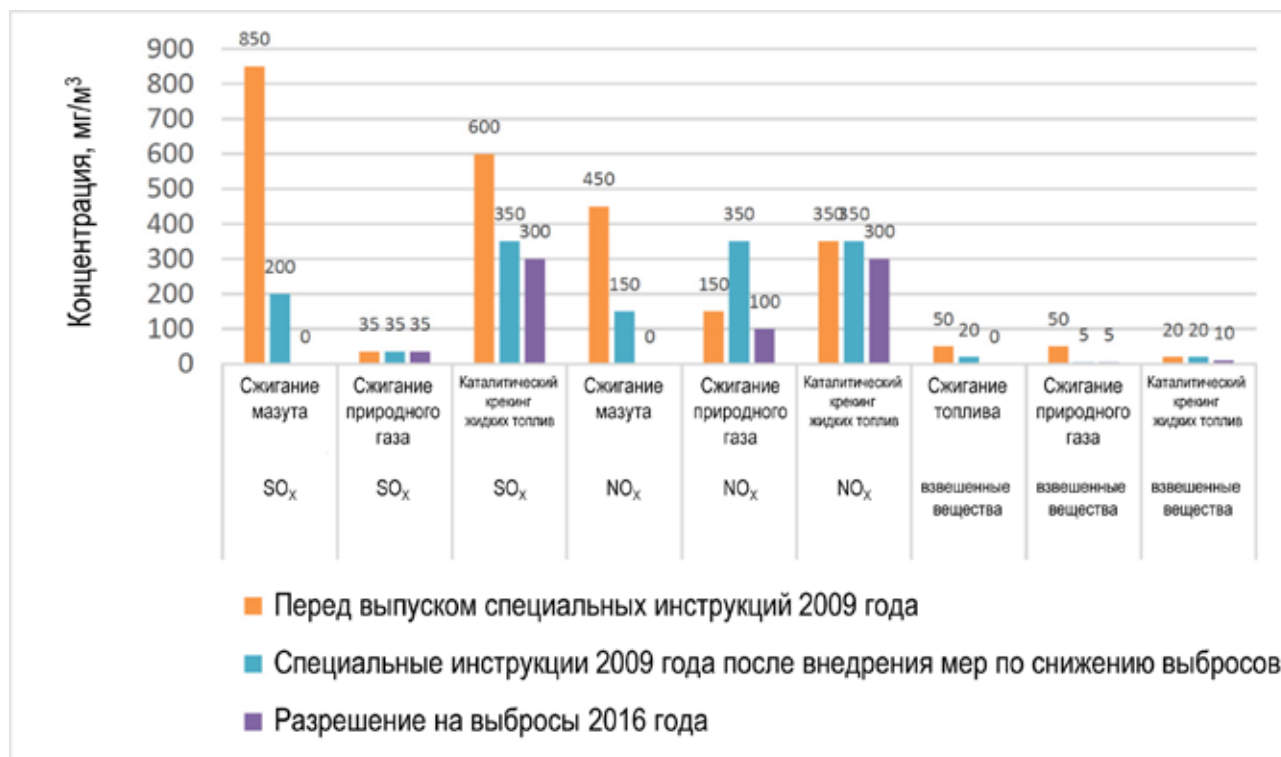
Рисунок 6.12. Изменения предельных показателей эмиссий SO x , NO x и ВВ Oil Refineries Ltd. между 2009 и 2016 гг.
